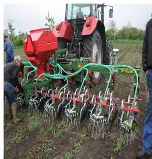
Billede 2. Thyregod radrenser med efterharve. Frøene skal spredes efter tænderne på radrenseren, og frøene skal harves ned med en efterharve monteret på radrenseren. (Foto: Rolf Thostrup Poulsen).
