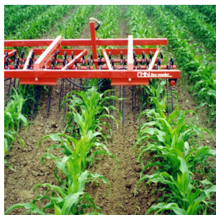
Billede 3. Græsfrøene skal spredes foran tænderne på langfingerharven, så frøene harves ned og dækkes med jord. (Foto udlånt af CMN Maskintec A/S).
